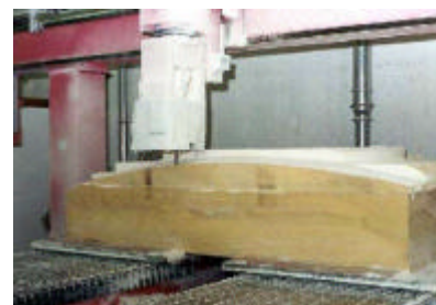
(f) Conformação térmica das chapas de acrílico sobre moldes de poliuretano.
