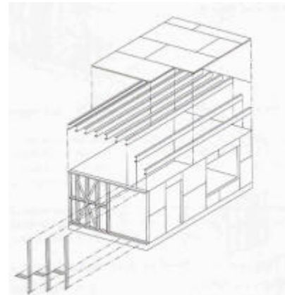
(a) Estrutura com elementos isolados: 'stick-build'
