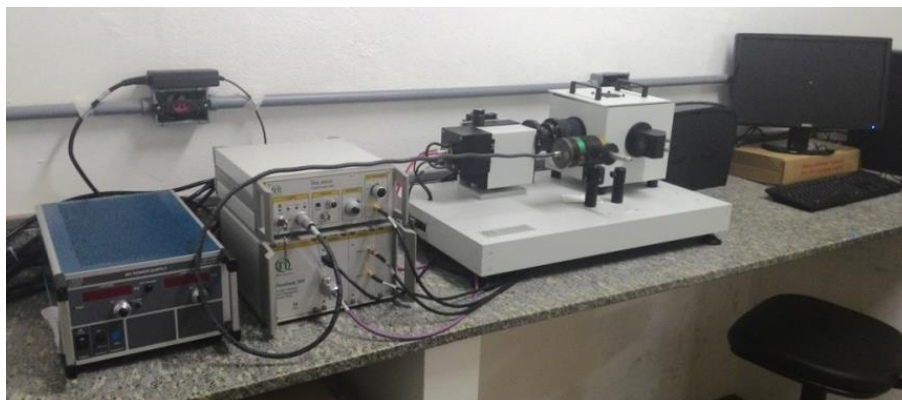
Figura 18 – Espectrômetro modular de fluorescência da Picoquant modelo Fluotime 200, localizado no Laboratório de Fotofísica Molecular, do Departamento de Física da Universidade Federal de Ouro Preto
