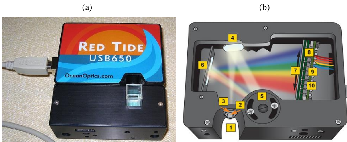
Figura 15 – (a) Espectrofotômetro modular da Ocean Optics modelo Red Tide USB650, localizado no Laboratório de Fotofísica Molecular no Departamento de Física da Universidade Federal de Ouro Preto. (b) Representação do sistema de detecção do espectrofotômetro modular Ocean Optics Red Tide USB650. Fonte 61
