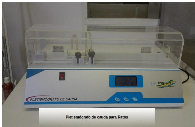
**Figura 03:** Foto ilustrativa do sistema de pletismografia de cauda utilizado.
