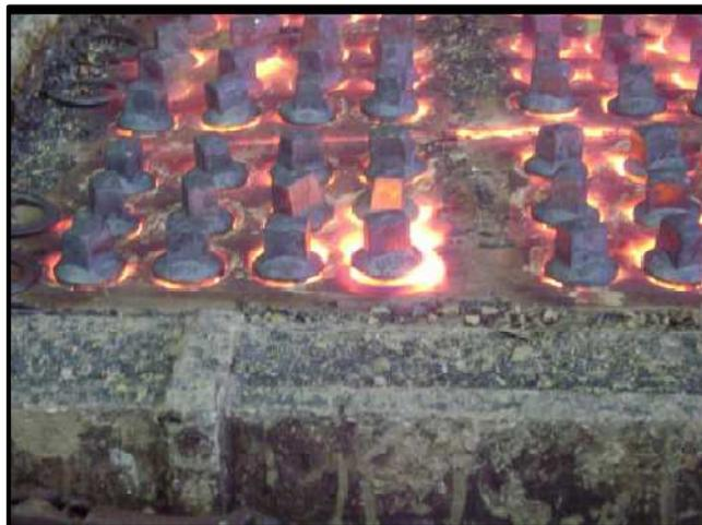
Figura 3.7: Aquecimento do parafuso *Tirefond* para laminação da rosca.
