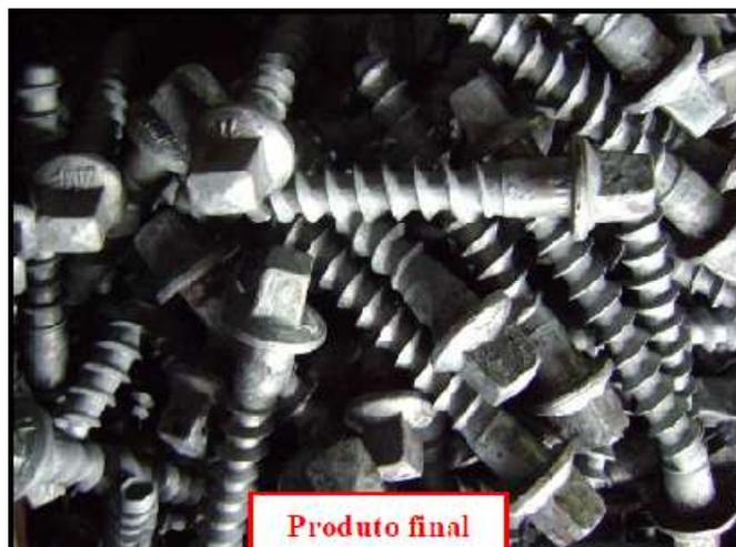
Figura 3.8: Parafuso Trefond após banho por imersão em óleo antioxidante.
