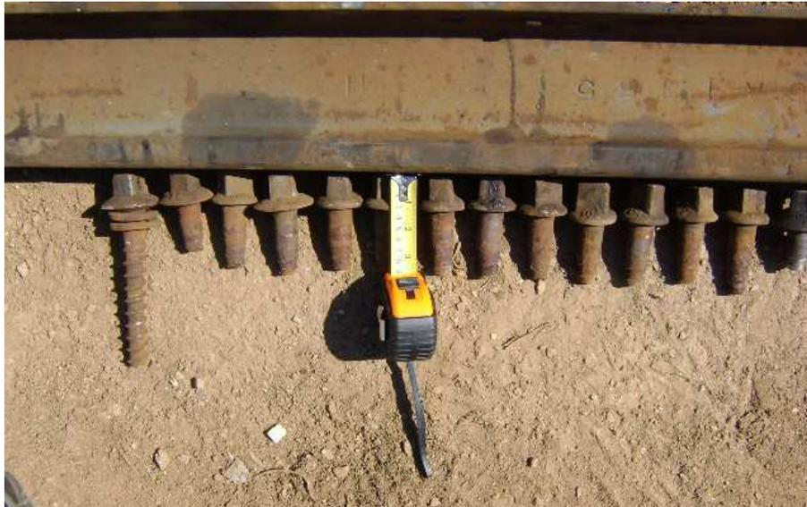
*Figura 1.2: Parafusos fraturados em campo.*
