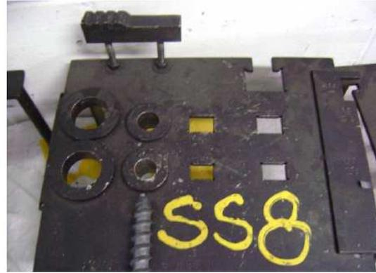
Figura 3.10: Equipamentos passa/não passa para aferição dimensional do Parafuso *Trefond*. a) da aba da cabeça do parafuso; b) da rosca e cabeça do parafuso.
