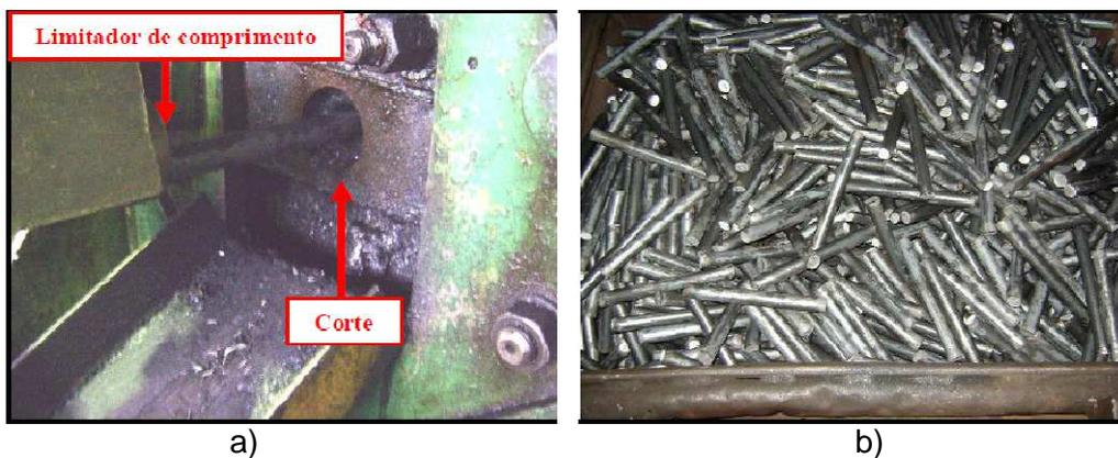
Figura 3.5: Corte das barras de aço ABNT 1015. a) Processo de corte das barras. b) Depósito de barras cortadas.
