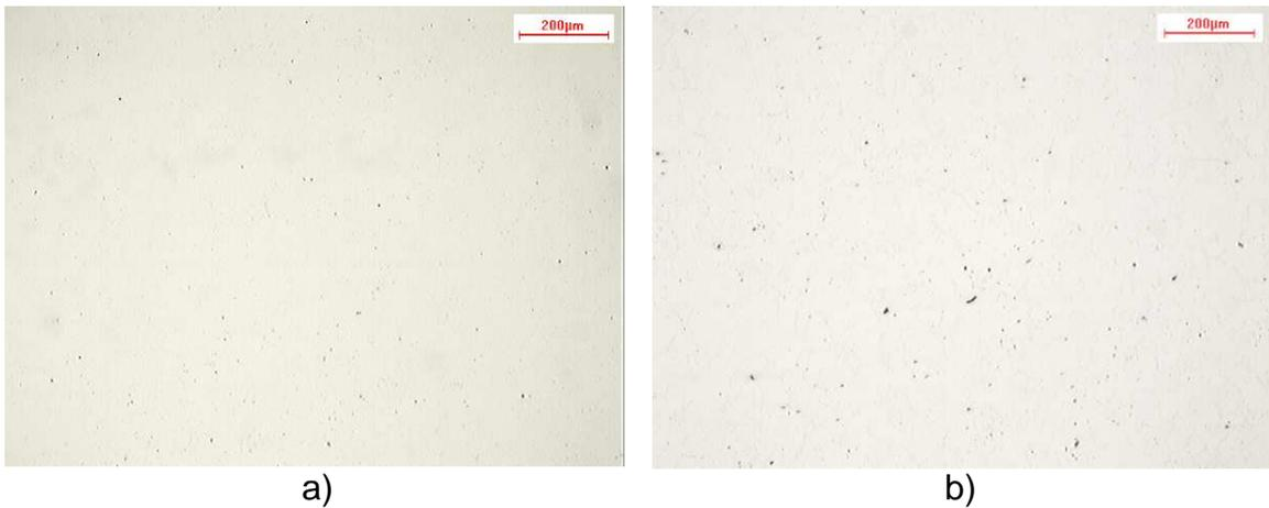
Figura 5.1: Micrografia do Parafuso Tirefond, sem ataque 100x: a) seção transversal; b) seção longitudinal.
