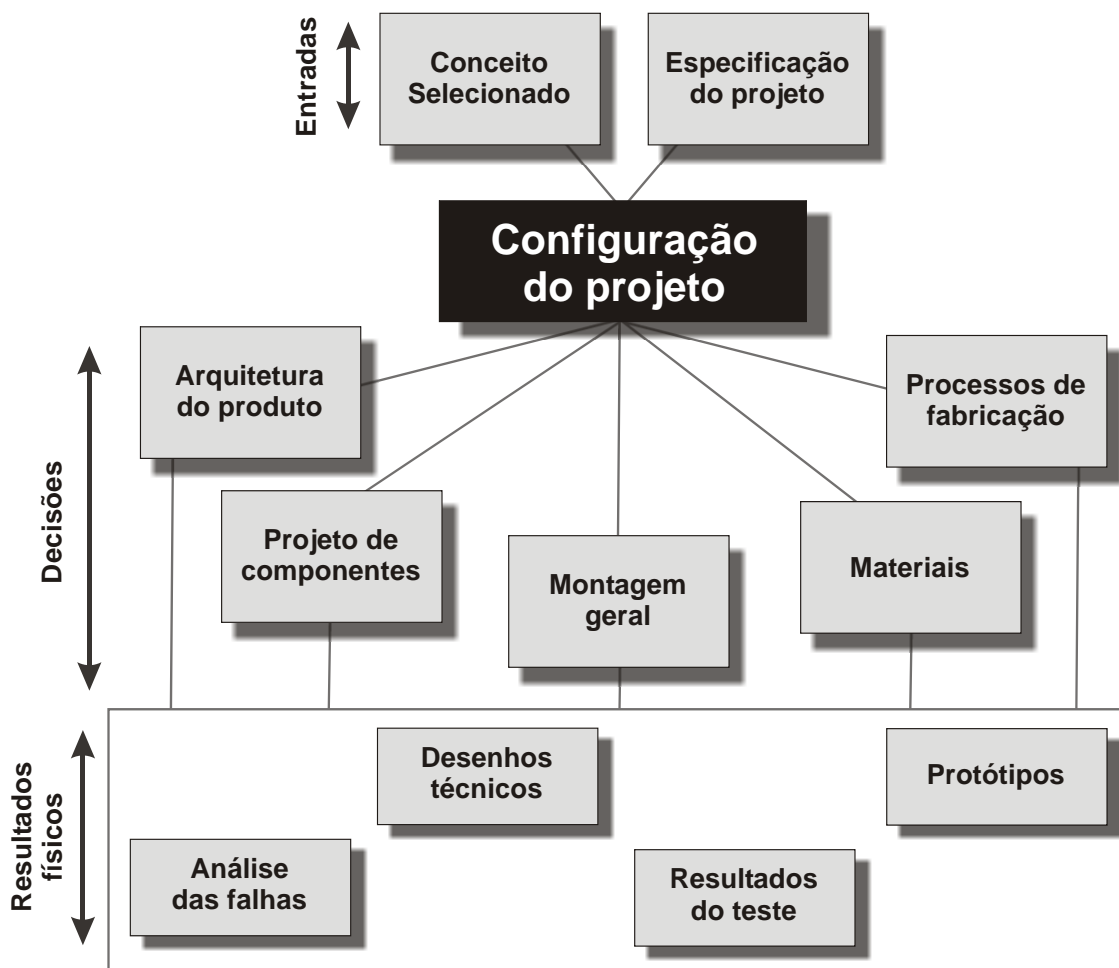
Figura 2.3 - Entradas e principais resultados da fase de configuração do projeto. Fonte: BAXTER, 1998
