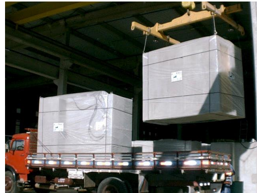
(b) módulos prontos sendo preparados para transporte
