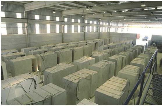
(a) módulos prontos em fábrica
