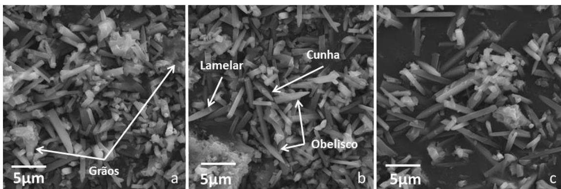
Fig. 5.43 - Micrografias dos whiskers desagregados da amostra TL5.Solta-1400.
