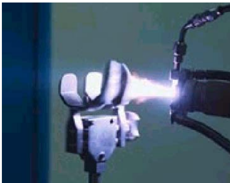
Figura 3.5 - Cobertura de prótese – CAM Implants, por pulverização com plasma. Substitutos de ossos e implantes reabsorvíveis podem ser produzidos quando a hidroxiapatita e outras variantes de fosfato de cálcio são utilizadas na fase cerâmica [42] .
