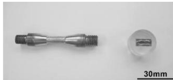
Figura 4.2: Corpo de prova de torção a quente (esquerda) e após embutimento para análise metalográfica (direita).
