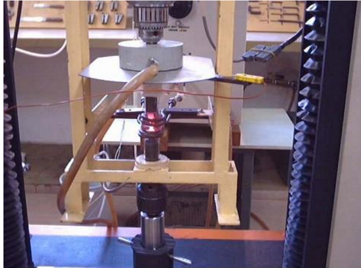
Figura 4.4: Modulo de Torção do Equipamento de Ensaio Mecânico INSTRON 1125 localizado no Instituto Senai de Inovação em Metalurgia e Ligas Especiais.
