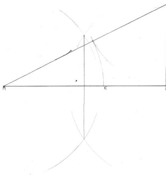
Utilizando a régua meça os segmentos AB, AC e BC e comprove que  $\frac{AB}{AC} = \frac{AC}{BC} = 1,618$
