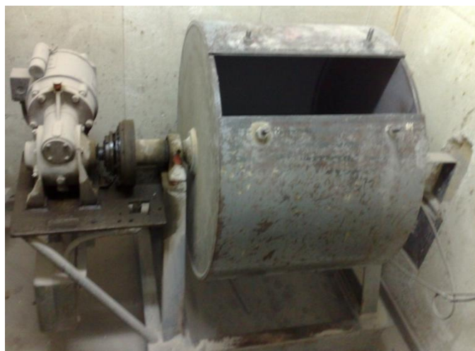
Figura 3.9 – Máquina Los Angeles utilizada para realização dos ensaios deste estudo.
