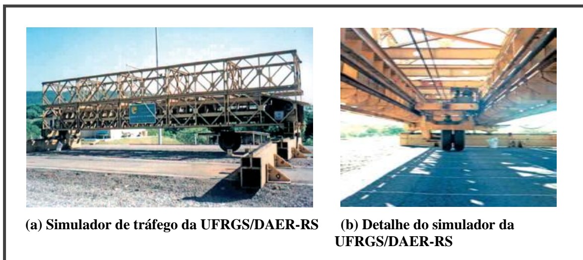
Figura 2.44 (a e b) – Simulador de tráfego da UFRGS/DAER-RS (BERNUCCI et al. , 2007).
