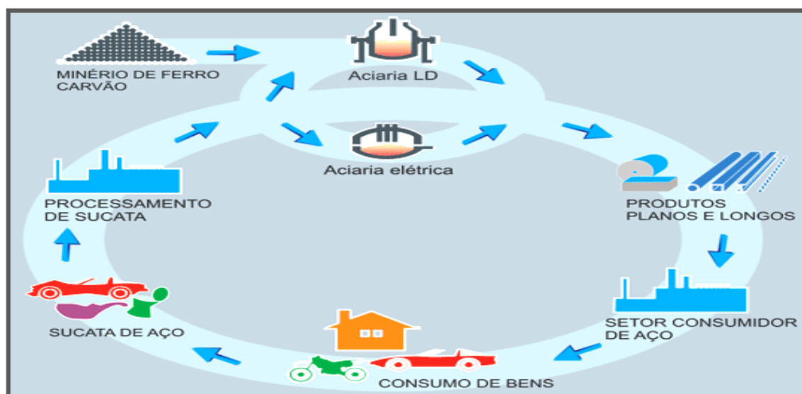
Figura 2.8 – Ciclo de refino do aço com reaproveitamento da sucata (IBS, 2008).
