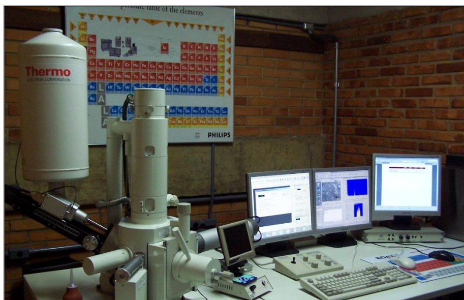
Figura 3.17 – Microscópio eletrônico de varredura do Laboratório de Geologia da UFOP.
