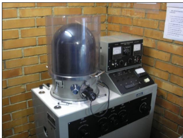
Figura 3.20 - Equipamento utilizado para metalização das amostras de escória de aciaria LD da USIMINAS para o ensaio de MEV realizado no DEGEO/UFOP.
