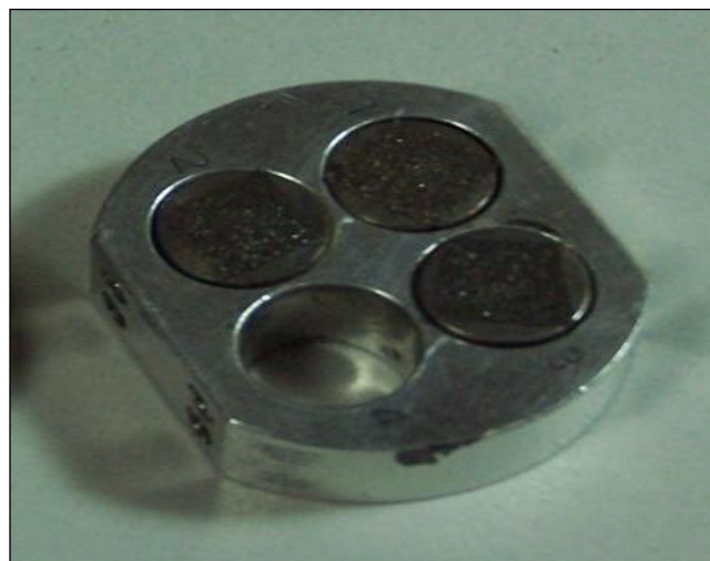
Figura 3.19 – Amostras de escória de aciaria da USIMINAS dispostas em pastilhas utilizadas no ensaio realizado pelo Departamento de Geologia da UFOP.
