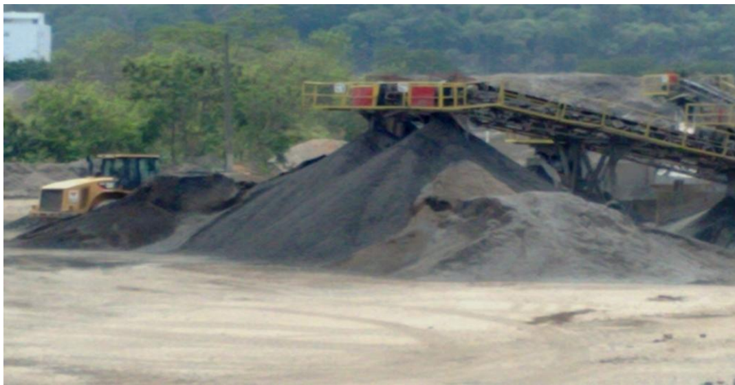
Figura 2.27 - Escória de aciaria britada estocada em pilhas.
