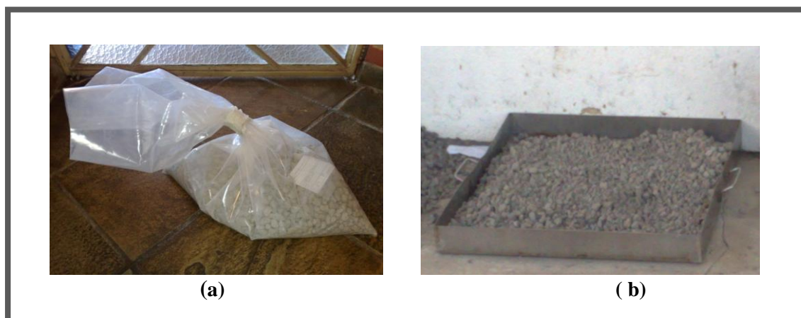
Figura 3.2 (a) e (b) – Amostras de escória de aciaria LD oriundas das pilhas de depósito da USIMINAS em Ipatinga MG utilizadas para os ensaios de PTM-130, DRX e MEV.
