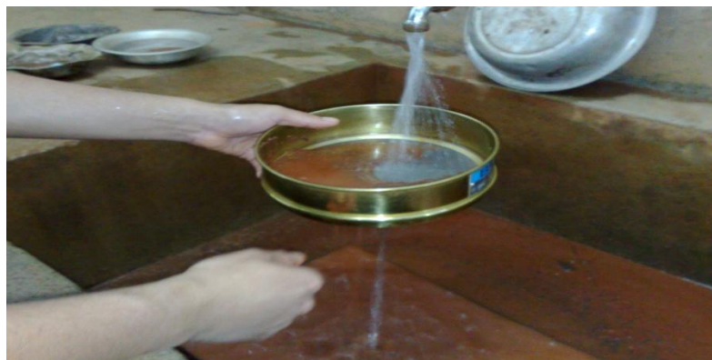
Figura 3.5 - Fração da amostra seca ao ar retida na peneira de 2,0 mm, sendo lavada para eliminação de material fino ainda aderente as partículas deste material.
