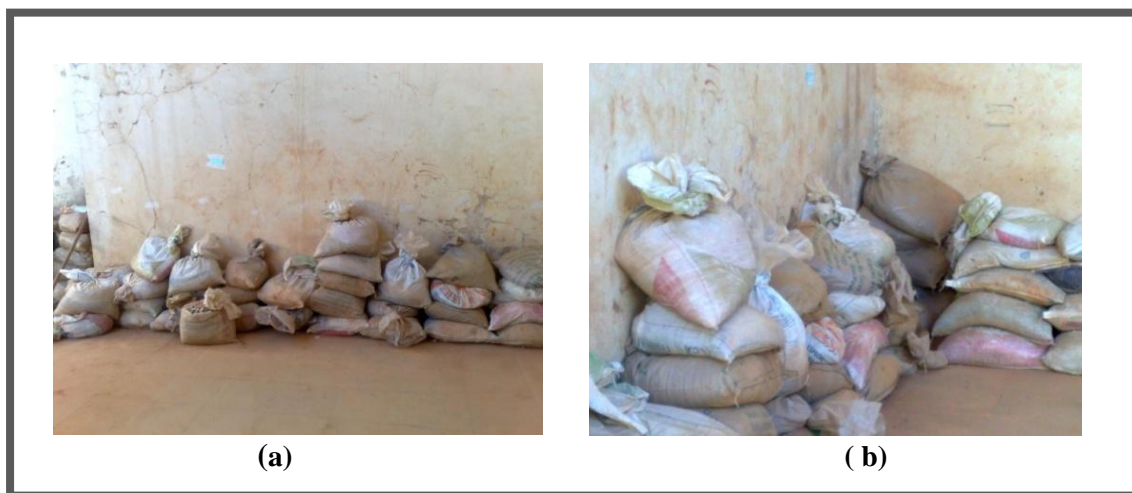
Figura 3.1 (a) e (b) – Amostras coletadas in loco na MG-232 – trecho: Mesquita/Santana do Paraíso - material de base, sub-base, reforço do subleito e do subleito.
