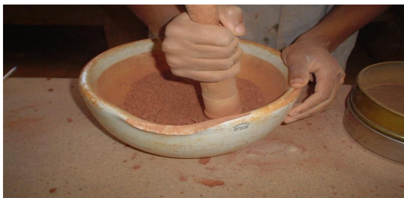
Figura 3.4 – Fração da amostra de escória de aciaria passante na peneira 2,0 mm sendo destorroado com a mão de gral no almofariz.
