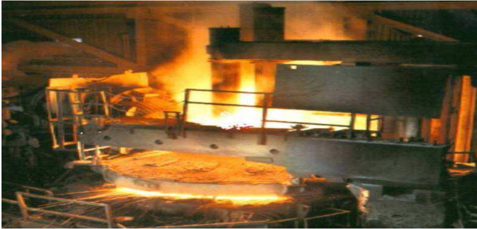
Figura 2.21 - Fusão em Forno Elétrico - EAF (SALES, 2005).
