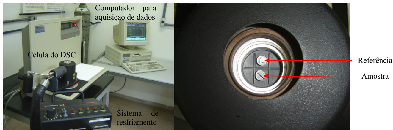
Figura 4.4 – DSC 2920 da TA Instruments e panelas de alumínio utilizadas nos ensaios sobre as plataformas do constantan.
