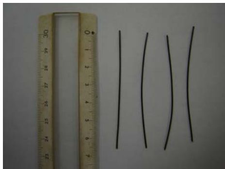
Figura 4.1 – Corpos de prova antes do ensaio de tração.
