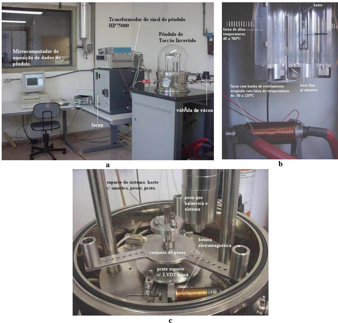
Figura 4.6 – Detalhes do pêndulo de torção invertido do CETEC, onde (a) mostra o sistema completo, (b) o módulo controlador, (c) o sistema de pesos e bobina de indução eletromagnética e (d) o compartimento de amostra e a mangueira para fluxo de óleo do banho que controla a temperatura.
