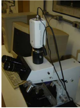
Figura 4.7 – Microscópio óptico com câmera para captura e computador para análise de imagens.
