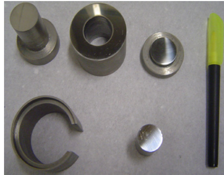
Figura 4. 1 - Matriz para confecção de pastilhas cerâmicas com diâmetro de 25 mm.
