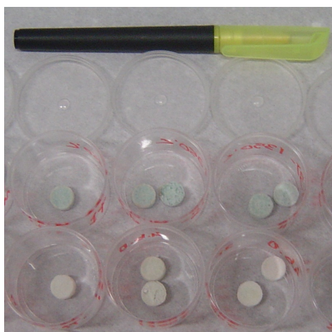
Figura 5. 5 - Amostras no formato de pastilhas, prensadas com 4 toneladas em matriz de 10 mm e sinterizadas até 1350 °C por 4h ao ar. Na linha superior, cerâmicas do pó Y e na linha inferior, cerâmicas de pó de osso bovino calcinado (PX-b).
