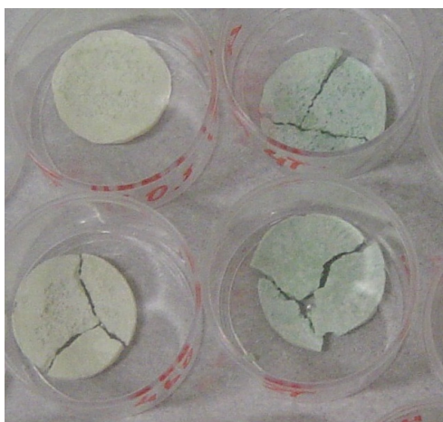
Figura 5. 4 – Pastilha composição 8 (esquerda) e 9 (direita) prensadas com carga de 4 toneladas em matriz de 25mm ( 80 MPa) e sinterizada à 1350 °C em forno elétrico ao ar.
