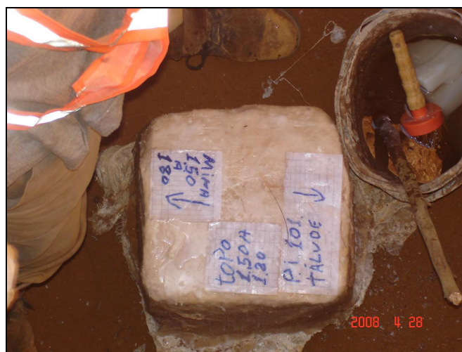
Figura 5.3 – Coleta de amostra indeformada no Poço PI -101
