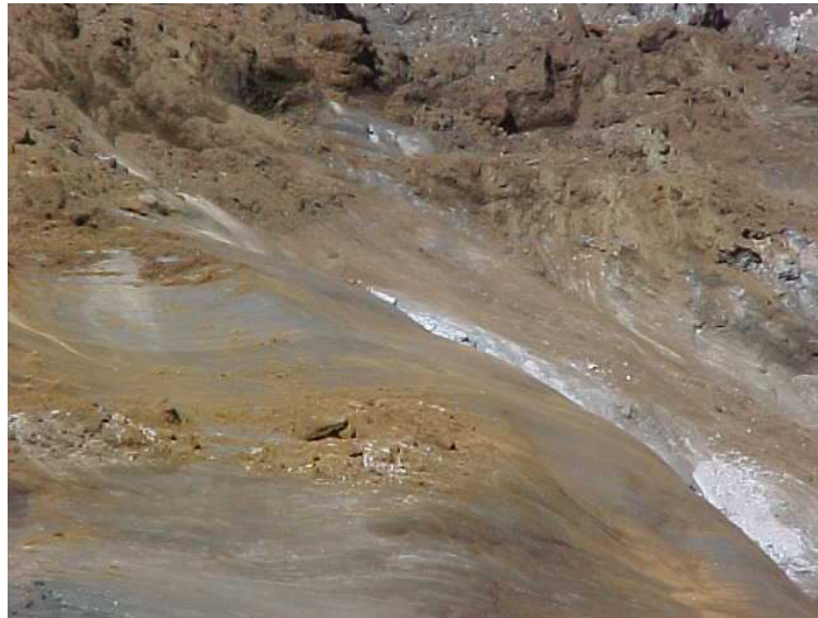
Figura 2.1 – Superfície de ruptura não circular ao longo de contato litológico complexo (Innocentini, 2003)
