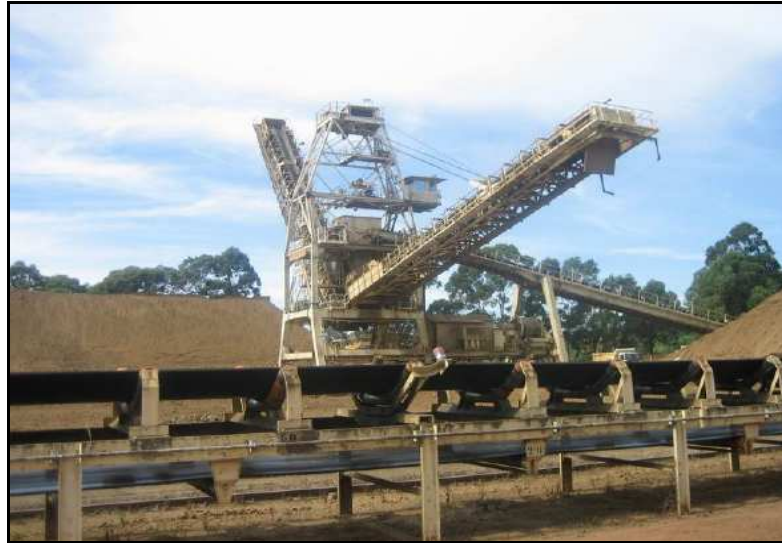
Figura 3.14 – Stacker e pilhas de homogeneização do minério bruto
