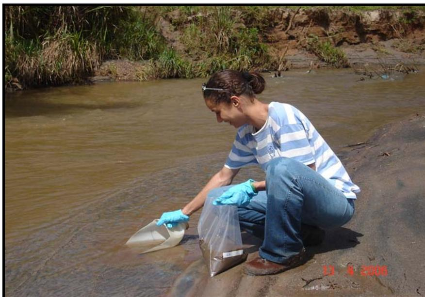
**Figura 2.4** - Foto representando o processo de amostragem dos sedimentos de fundo.
