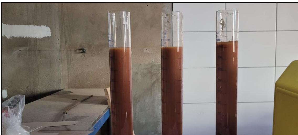
Figura 18. Ensaio de granulometria por sedimentação.
