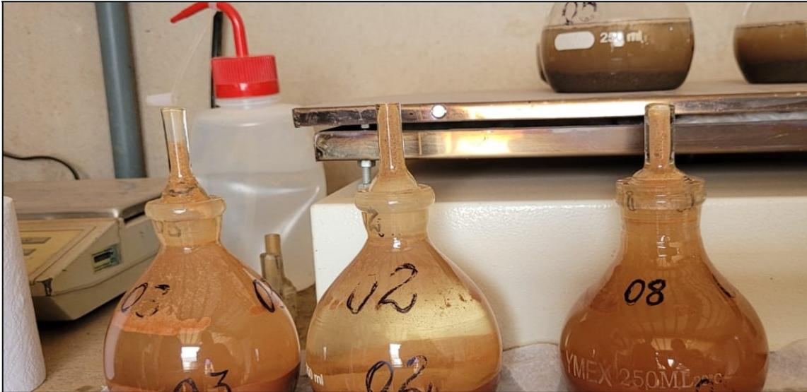
Figura 20. Ensaio de determinação da massa específica.
