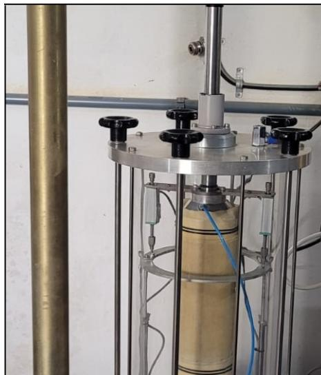
Figura 24. Determinação das deformações permanentes.
