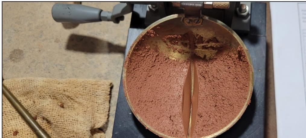
Figura 19. Ensaio de determinação do Limite de liquidez.
