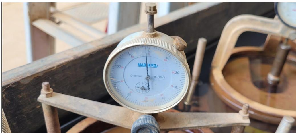
Figura 22. Imersão em água dos corpos de prova para a determinação do CBR.
