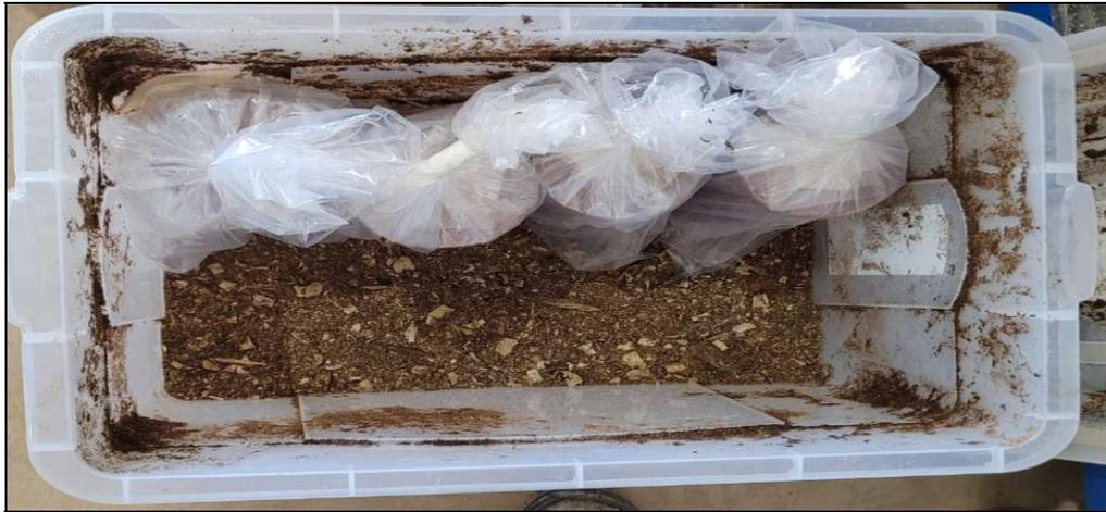
Figura 23. Cura dos corpos de prova selados e enterrados em pó de serra saturada de água.
