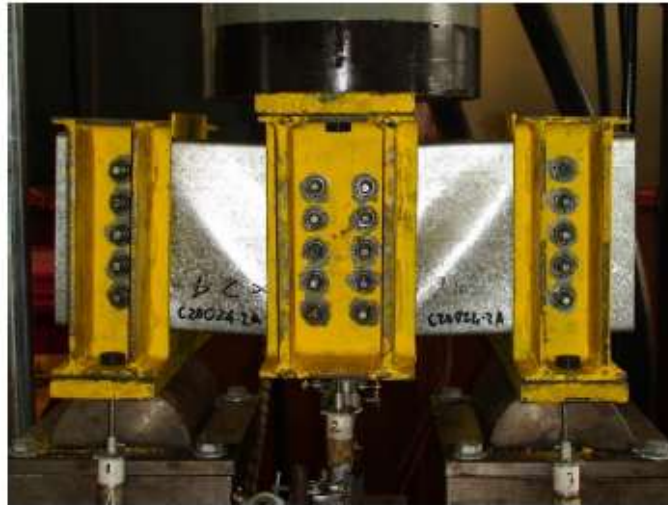
Figura 3.7 – Configuração do experimento com detalhe na chapa lateral à alma do perfil e modo de falha por cisalhamento realizado por Pham e Hancock (2009a e 2009b)
