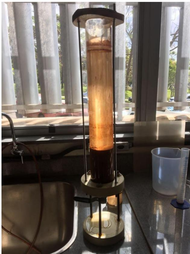
Figura 36: Ensaio de sedimentação em coluna nos laboratórios de tratamento de resíduos do DEMIN/UFOP.
