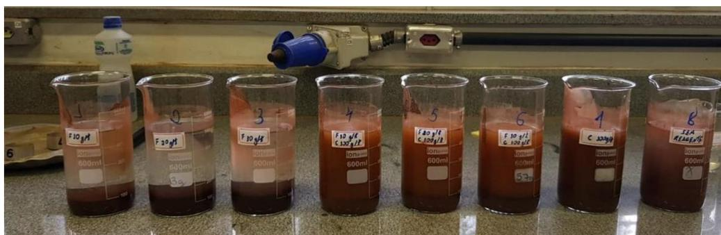
Figura 35: ensaios de sedimenta o em b quer nos laborat rios de tratamento de res duos do DEMIN/UFOP.
