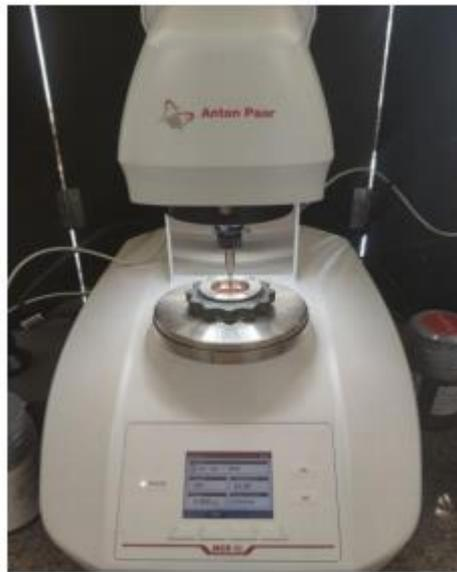
Figura 8: Reômetro durante ensaio reológico (CHÁCARA, 2020).
