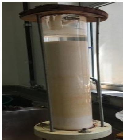
Figura 37: Teste de sedimentação de caulinita com 48 horas de duração.
