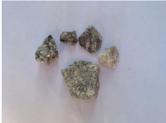
Figura 10 - Fração brita após limpeza com ácido clorídrico.
