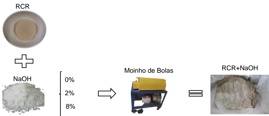
Figura 7 - Processo de mistura do RCR e NaOH.
