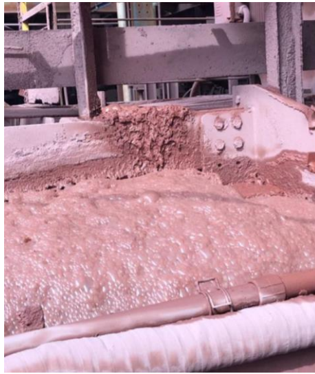
Figura 5 – Flotação de zinco utilizando célula mecânica
