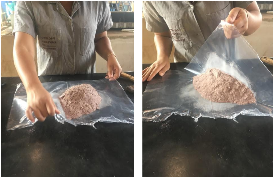
Figura 19 – Etapas de homogeneização e quarreamento em pilhas cônicas
