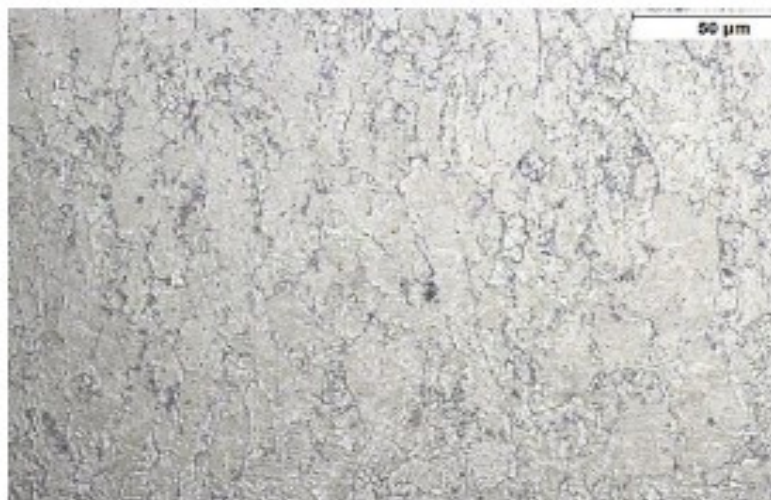
Figura 16: Microestrutura em microscopia óptica do aço 410D em seu estado de entrega - ataque à quente com reativo colorante – 500x.
