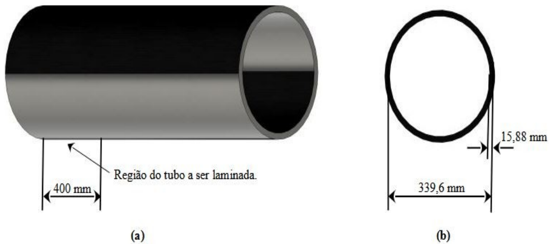
Figura 27: Desenho esquemático ilustrando as regiões e dimensões de amostragem do estado de entrega a partir de um tubo de aço sem costura laminado e resfriado ao ar (a) seção longitudinal; (b) seção transversal.
