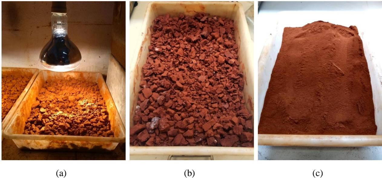
Figura 7 - Processamento da Lama Vermelha: pré-secagem em lâmpada infravermelho (a); material após secagem em estufa a 105° C (b); após moagem (c).
