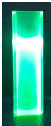
Figura 99. Imagem do composto 56 sob irradiação de luz UV (365 nm em cubeta de quartzo)
