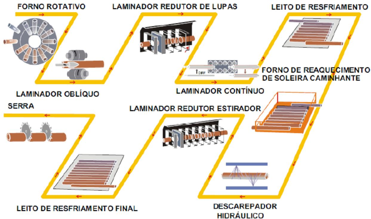
**Figura 3.3** - Representação da laminação de tubos pelo Processo *Mannesmann* [18].
