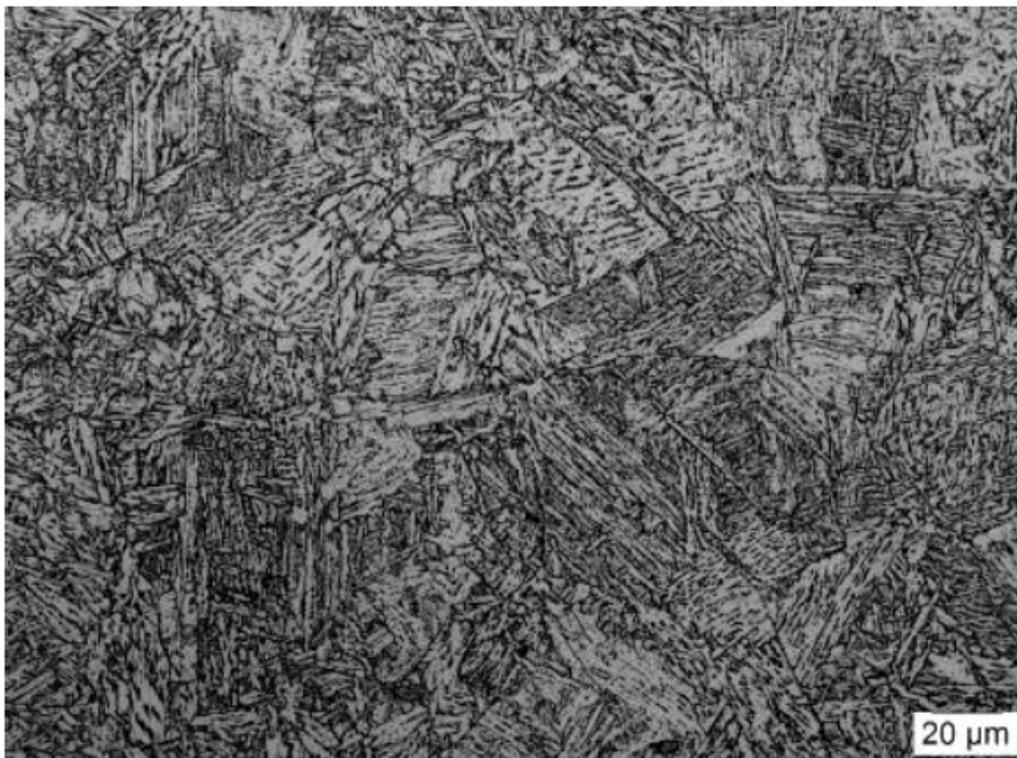
**Figura 5.9** - Microestrutura na região de topo da ZTA para tubo grau API 5L X70 soldado com aumento de 1000x - Ataque Nital 3% [63].
