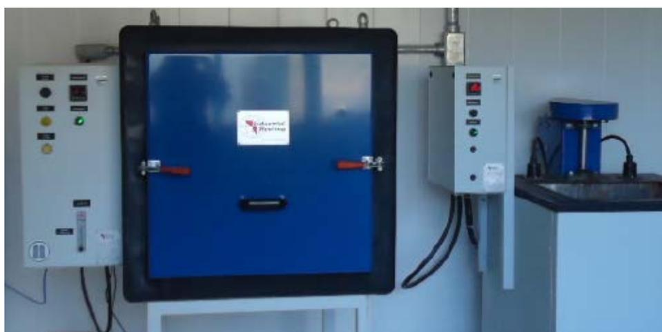
**Figura 4.8** - Forno de austenitização e tanque de água para a realização do processo de têmpera.
