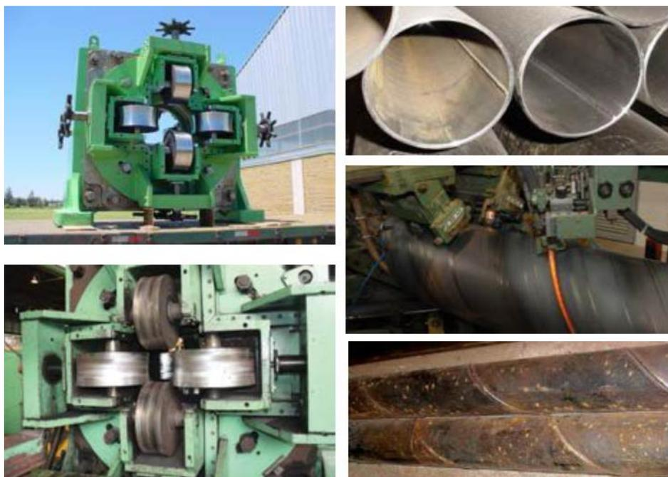
**Figura 12.** Tubos com costura, conformação e solda
