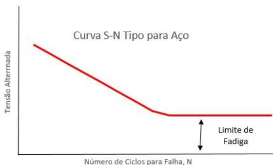
Figura 1 - Diagrama Padrão Curva S-N para Aço
