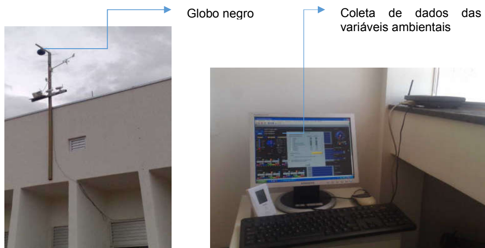
Figura 2-5: (a) - Globo negro externo e estação meteorológica. (b) - equipamento de coleta de dados da estação meteorológica.
