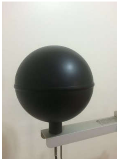
Figura 3-8: Termômetro de globo negro - Modelo ALMEMO Class B (DIN/IEC 751)
