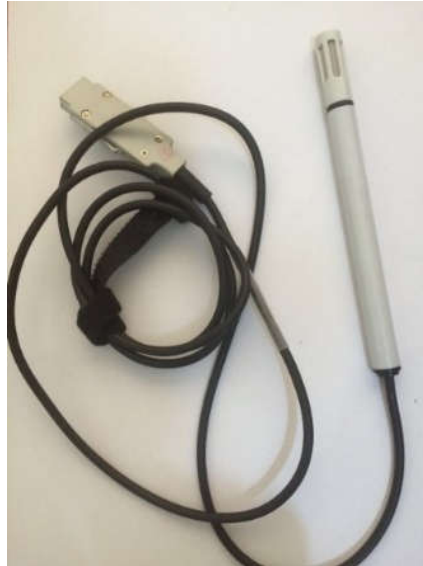
Figura 3-7: Sensor de temperatura e umidade - Modelo ALMEMO 3290
