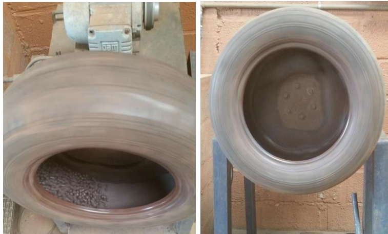
Figura 4.2. Pneu para pelotamento em escala de bancada: detalhe da produção de pelotas (esquerda)
