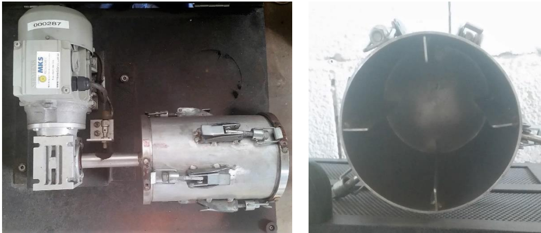
Figura 4.6. Tambor padronizado para tamboramento no ensaio RDI . À Direita, detalhe do seu interior
