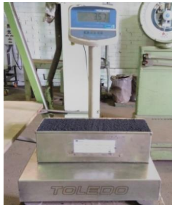
Figura 4.5: Determinação da densidade para o CMC a partir de um recipiente de volume conhecido.
