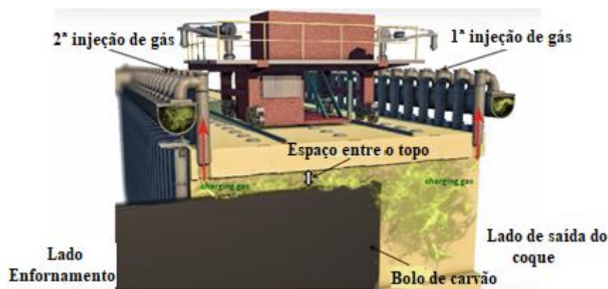
Figura 3.52: Vista lateral do “bolo” de carvão enformado e com sistema de coleta e injeção de gás na parte superior (ZINGERMAN, 2014).
