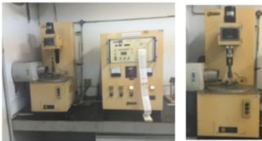
Figura 4.3: Plastômetro usado para o teste de fluidez.
