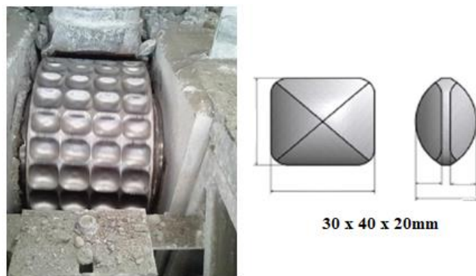
Figura 4.7: Rolo compactador com cavidades em formato de travesseiro.
