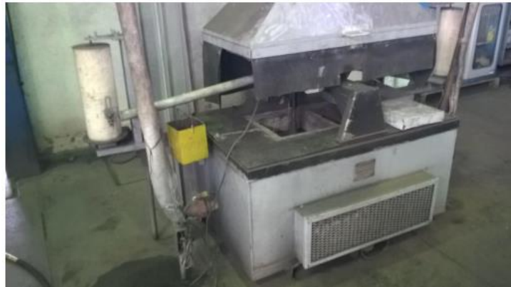
4.6: Forno de soleira aquecida da Gerdau Ouro Branco (ALVES, 2017).
