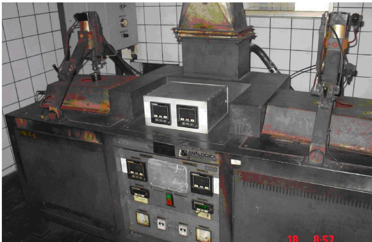
Figura 1. Esquema de forno de soleira aquecida [6].
