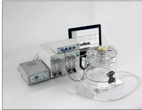
Figura 3.2: Fotografia do sistema de pletismografia de corpo inteiro (EMKA, Technologies, FR).
