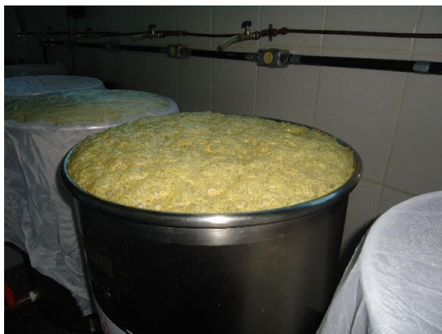
Figura 12 – Dorna em aço inoxidável com volume útil de 40 L em processo fermentativo, utilizada na fermentação em escala piloto no laboratório de microbiologia do IFNMG – Campus Salinas.
