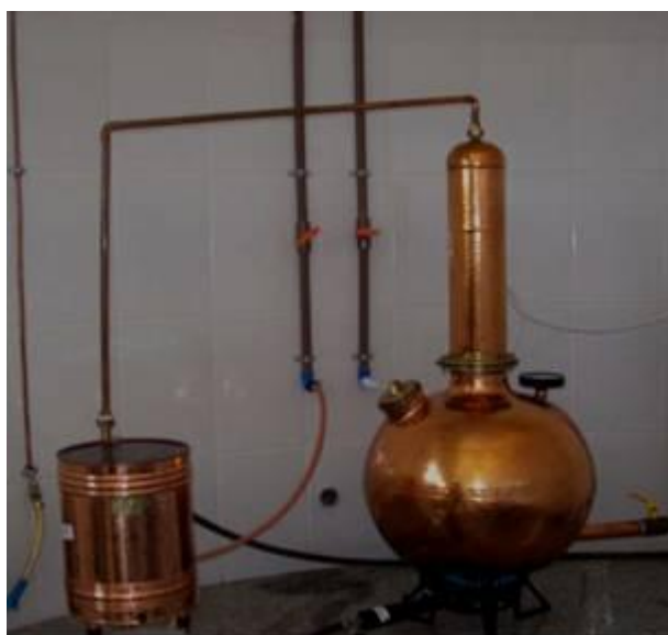
Figura 13 – Alambique de cobre para obtenção da cachaça, volume útil 40 L e aquecimento com fogo direto.
