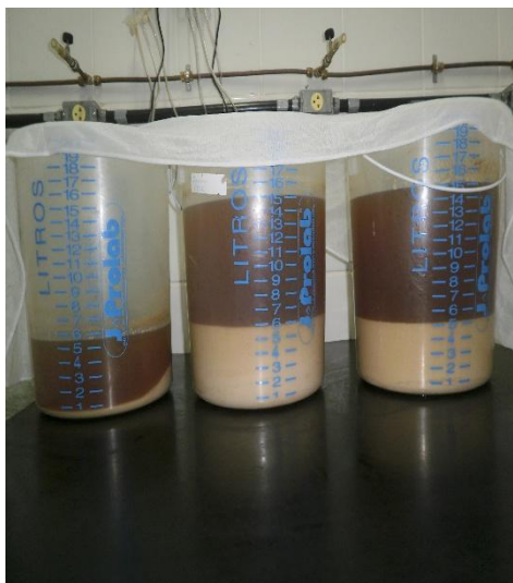
Figura 11. Processo de multiplicação das linhagens de leveduras da linhagem LBCM 675, selecionada na microrregião de Salinas, utilizando baldes plásticos com capacidade de 20 L e caldo de cana-de-açúcar estéril diluído a 5 °Brix.
