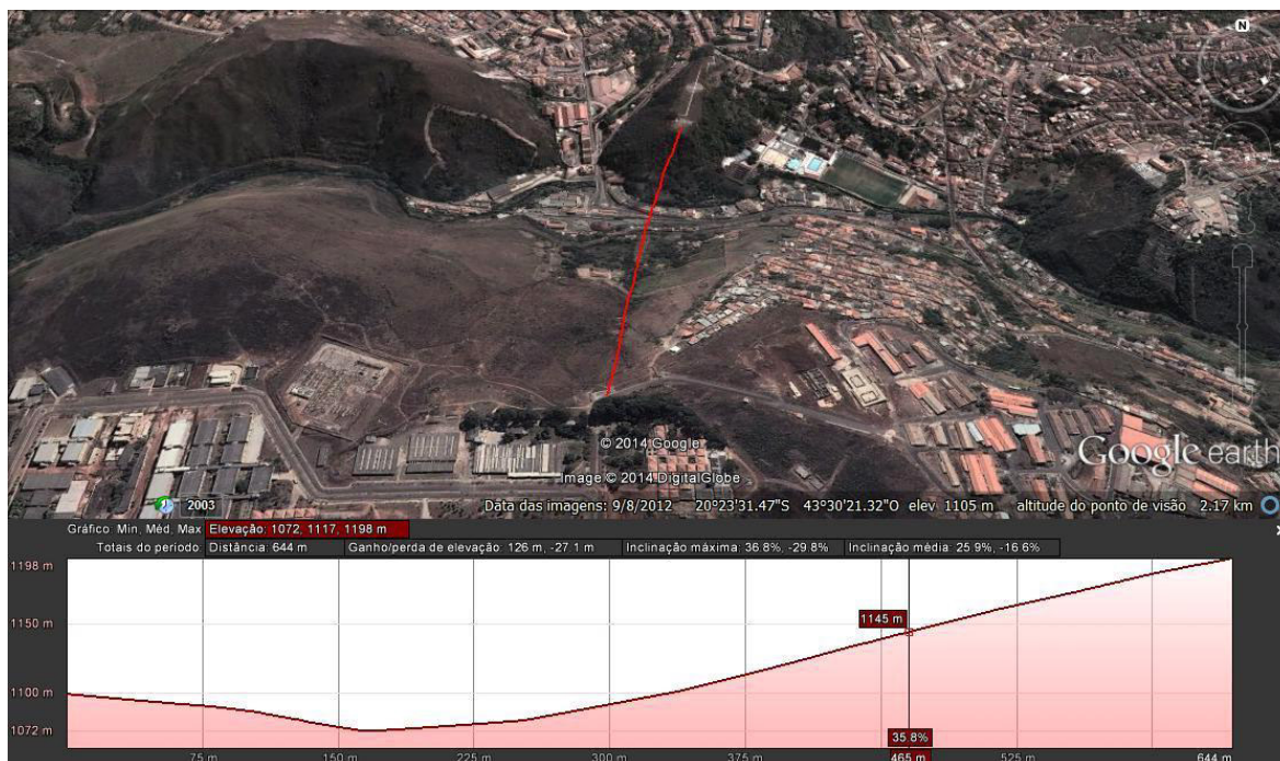
Figura 8 - Traçado e perfil do terreno sob o trajeto do teleférico
