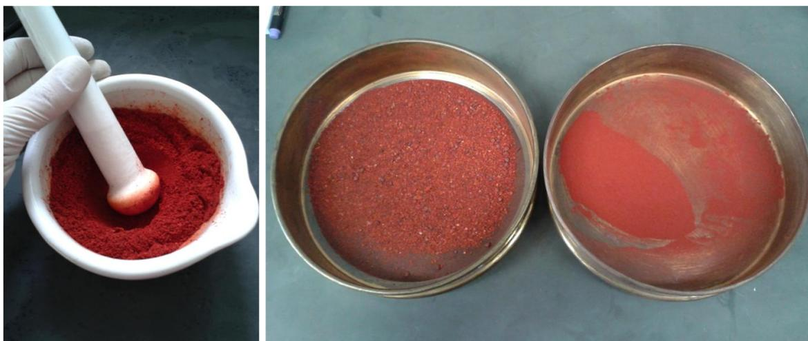
**Figura 8:** À esquerda um dos extratos em pó após a filtragem sendo macerado e, à direita, o extrato em pó após a passagem pela peneira de 200mesh (os extratos em pó de todos os tempos de ultrassom apresentam aparência semelhante).
