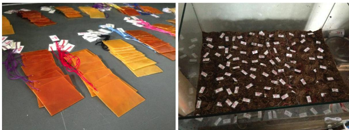
**Figura 13:** À esquerda, amostras antes de serem enterradas para o ensaio de biodegradação e, à direita, as amostras já enterradas para a realização da biodegradação
