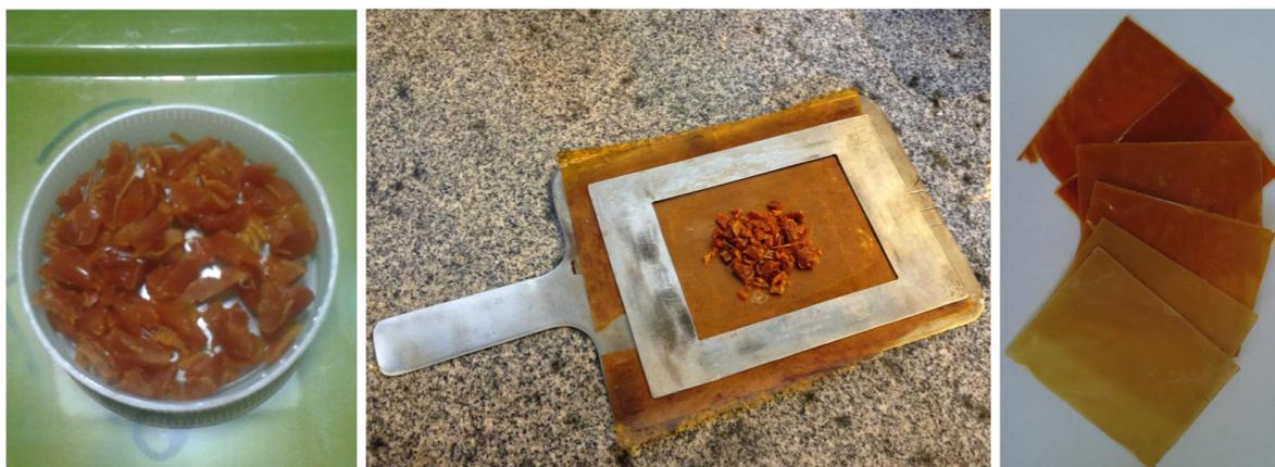
**Figura 10:** Processo para obtenção das lâminas de cada mistura. À esquerda, o polímero após a passagem pelo moinho de facas, ao centro, o polímero posicionado no interior do molde, para ser, posteriormente, fechado e prensado, e, à direita algumas das lâminas obtidas por meio desse processo (as misturas de PHB com os colorantes apresentam aparência semelhante, podendo a imagem representar a todas as misturas).
