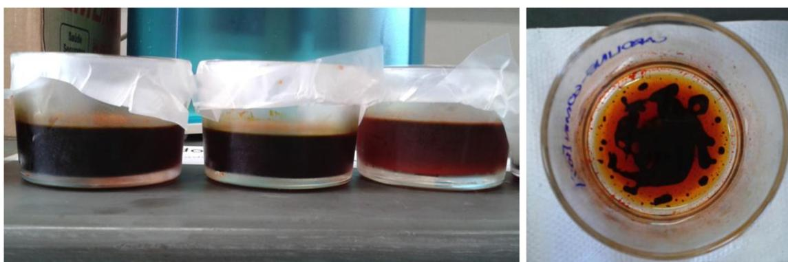
**Figura 7:** À esquerda, os líquidos obtidos após a filtragem a vácuo, à direita, o líquido de um dos tempos de extração após a secagem parcial em estufa para obtenção da pasta.
