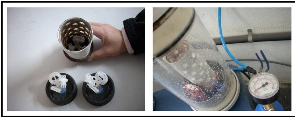
FIGURA 6.3. Preparação dos moldes: colocação das peças na base para ser posicionada dentro do tubo (esq) e aplicação do vácuo no momento de inclusão do gesso (dir).
