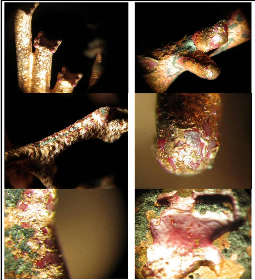
FIGURA 6.15. Detalhes das inclusões observadas na peça fundida em cobre
