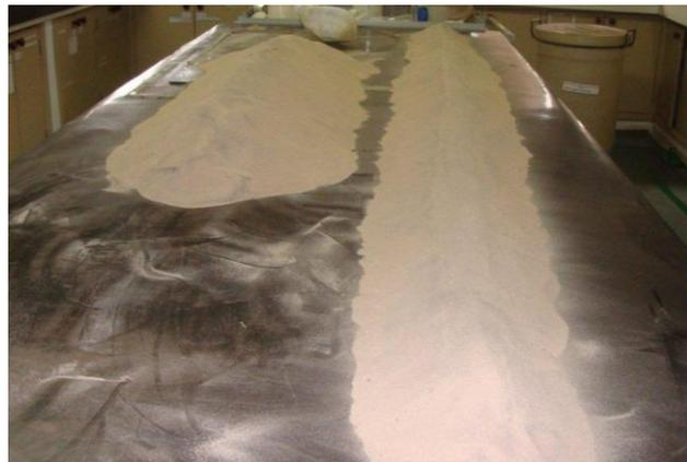
Figura 4-2 – Foto do processo de homogeneização
