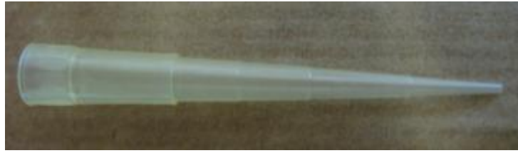
Figura 4.11: Ponteira utilizada nos ensaios realizados com a pipeta multicanal eletrônica, seu destacando o formato cônico e a ausência do êmbolo interno.
