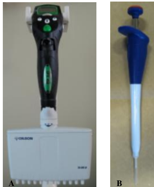
Figura 3.2: Fotografias das pipetas utilizadas nos ensaios de agregação. A – Pipeta multicanal eletrônica com 12 canais. B – Pipeta monocanal com deslocamento positivo. Nota-se a presença de um êmbolo na ponteira da pipeta B
