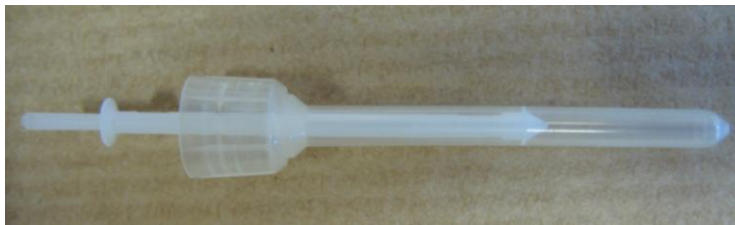
Figura 4.12: Ponteira utilizada nos ensaios realizados com a pipeta monocanal específica para líquidos viscosos, destacando seu formato cilíndrico e a presença do êmbolo interno.
