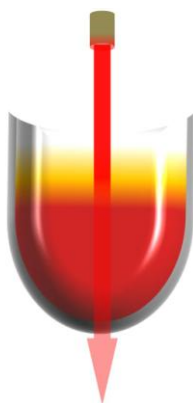
Figura 4.5: Esquema representativo da direção do feixe de luz que atravessa o micropoço, durante as leituras no leitor de microplacas.
