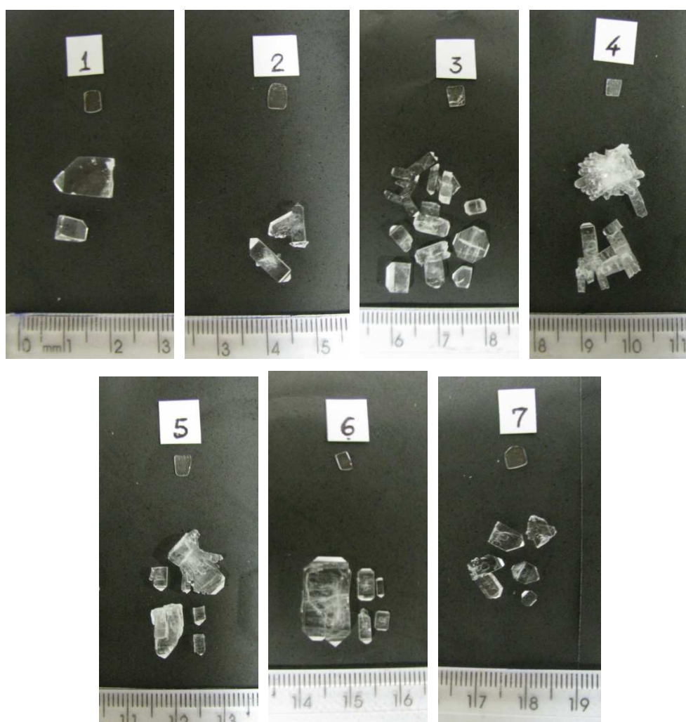
Figura 9: (1) Cristais puros de KDP, cristais da espécie mista KADP_x , sendo (2) x = 0,076 , (3) x = 0,118 , (4) x = 0,357 , (5) x = 0,857 , (6) x = 0,942 e (7) cristais puros de ADP e a respectiva placa de cada grupo de amostras, para a obtenção das medidas elétricas.
