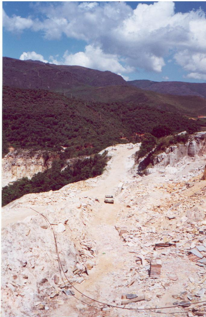
Figura 1 – Vista geral de uma das unidades de exploração do quartzito da região de Ouro Preto, mostrando a precariedade das vias de acesso, a aleatoriedade do desenvolvimento das frentes de lavra e a deposição descontrolada de rejeitos e estéreis (Lima e colaboradores, 2005).
