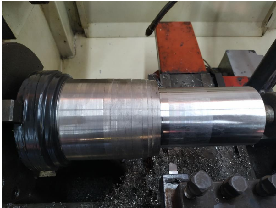
Figura 15 - Peça da liga de titânio Ti-6Al-4V utilizada nos ensaios.
