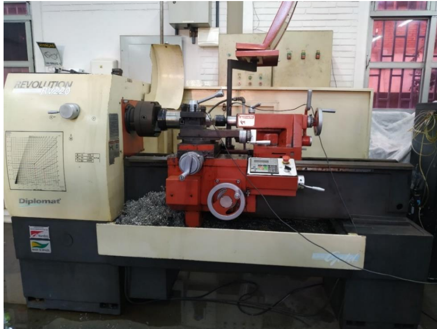
Figura 19 - Torno eletrônico universal Diplomat® modelo Revolution RV-220 utilizado nos testes.
