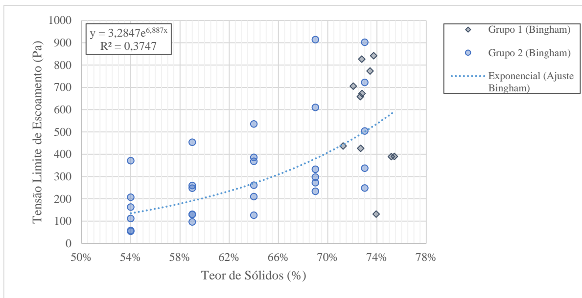
Figura 5.56 - Tensão Limite de Escoamento versus Teor de Sólidos – Amostras deformadas e indeformadas – Modelo Matemático de Bingham
