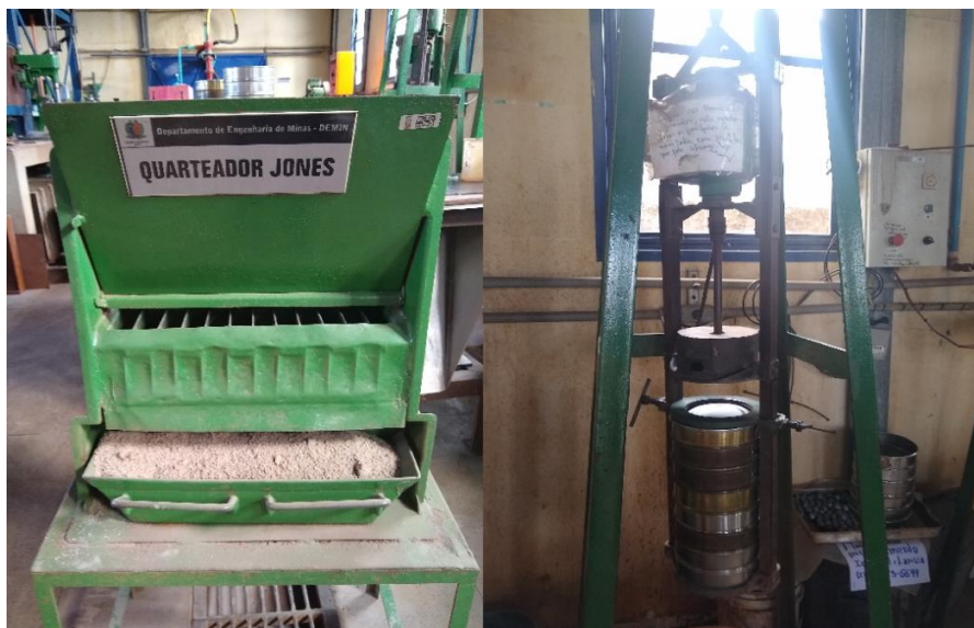
Figura 10 — Imagem ilustrativa do quarteador do tipo Jones (a) e do peneirador mecânico (b)
