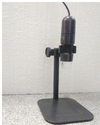
Figura 12 — Imagem ilustrativa do microscópio do tipo caneta utilizado nos estudos para determinação da área das partículas
