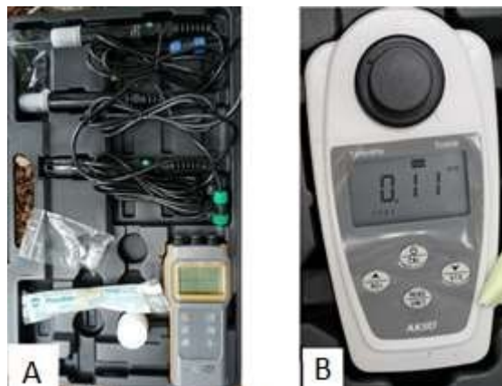
Figura 4.1 - A) Medidor multiparâmetro - AK88 Akso e B) Turbidímetro Digital - TU430 Akso (Elaboração da autora).
