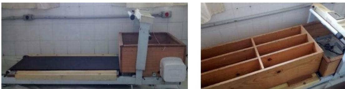
Figura 2.1: Esteira elétrica adaptada com seis baias para treinamento de exercício físico de pequenos animais.
