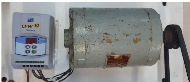
Figura 3.14: Motor e o inversor de frequência utilizados para a movimentação.
