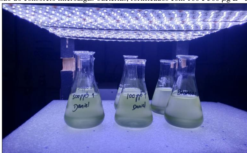
Figura 5.5 – Frascos erlenmeyers (250 mL de capacidade) utilizados nos testes preliminares contendo a suspensão do consórcio microalgas-bactérias, fortificados com 100 e 500 \mu\text{g L}^{-1} de SMX.
