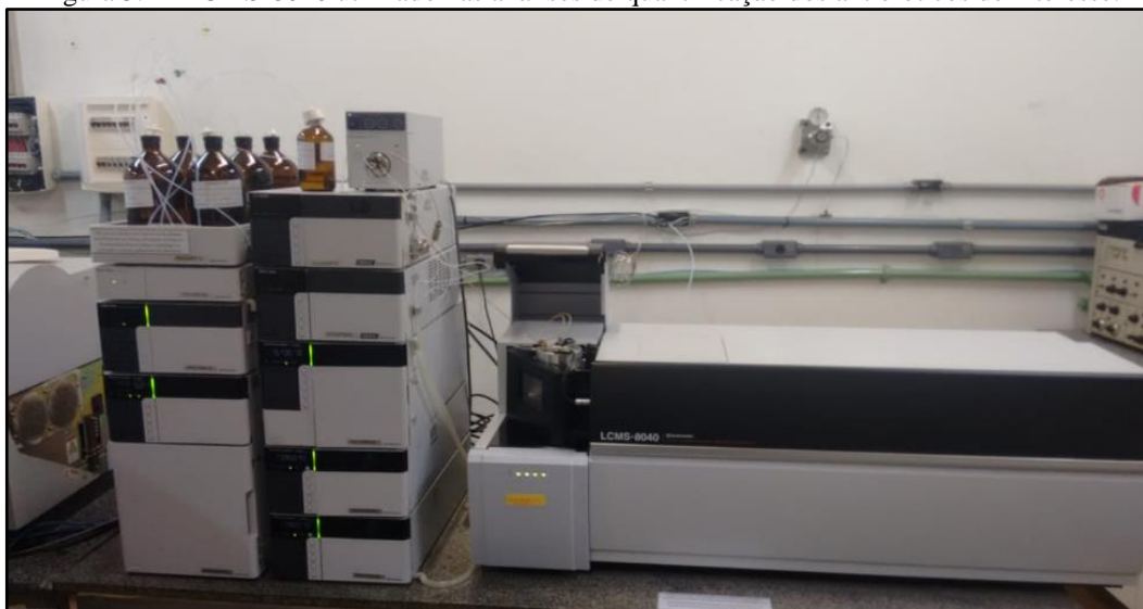
Figura 5.2 - LCMS-8040 utilizado nas análises de quantificação dos antibióticos de interesse.
